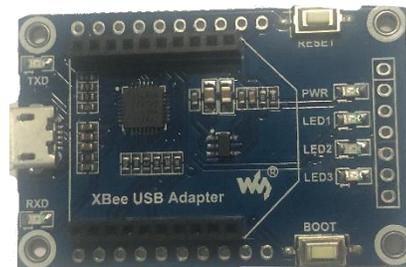
**Figura 1.9 Adaptador USB – Xbee.**
