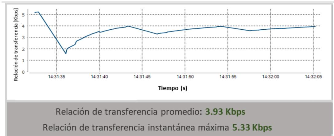
Figura 3.7 Tasa de bits a 30 metros con línea de vista.
