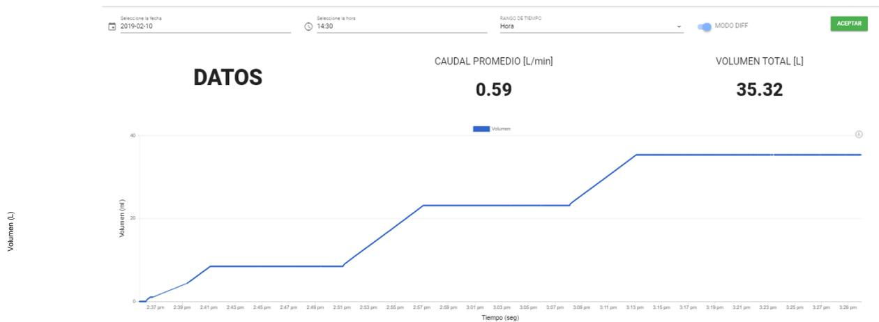
**Figura 3.11 Interfaz web – Análisis del volumen de agua por intervalos de tiempo.**
