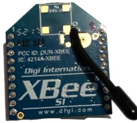
**Figura 1.8 Módulo de comunicación XBee S1.**
