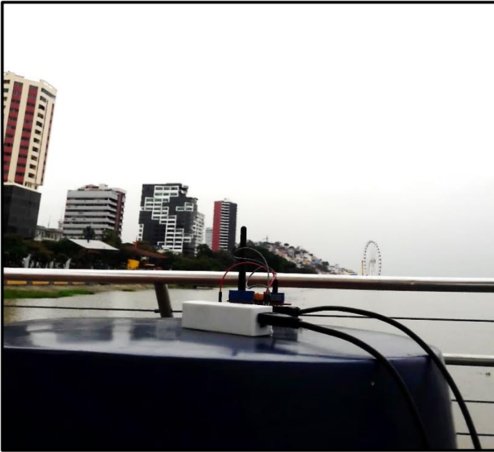
Nodo 1 ubicado en la plaza Neoclásica en el Malecón 2000 colocado al nivel del suelo, apuntando hacia el Gateway.
