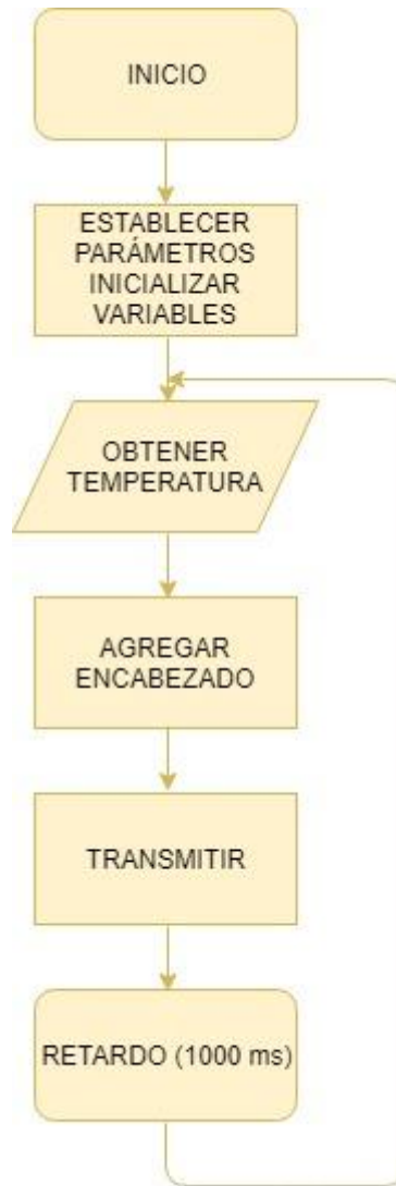
Figura 2.8: Diagrama de flujo del procedimiento de configuración del nodo sensor.
