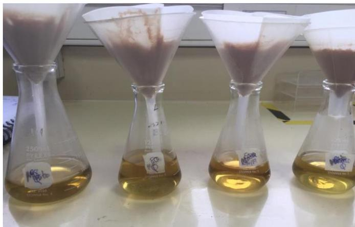
**Figura 3.11 Filtración de mostos**
