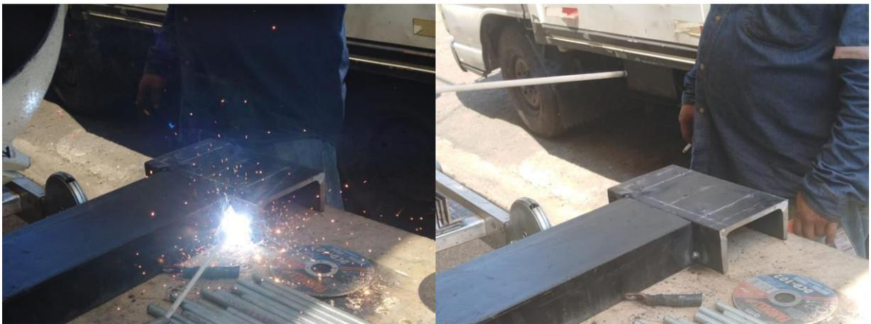
Figura E.2 Construcción de bancada
