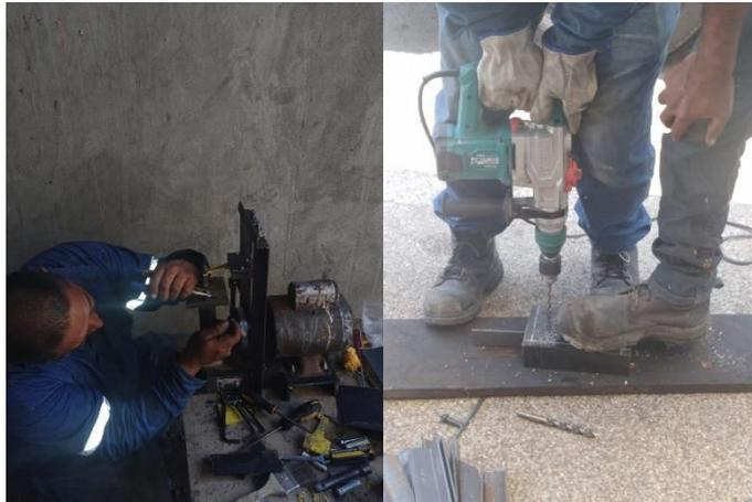
**Figura E.5 Perforado y armado de mecanismo**
