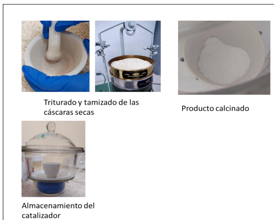
Figura 2-2. Pasos para síntesis del catalizador
