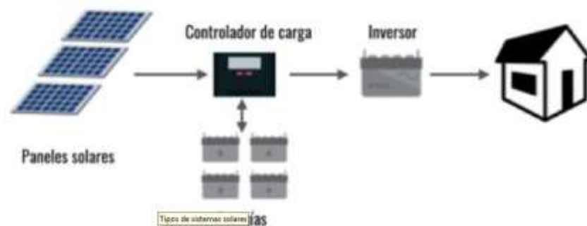
Ilustración 16 Sistema solar fotovoltaico con baterías con inversor para cargas AC. Fuente: https://www.sunsupplyco.com .
