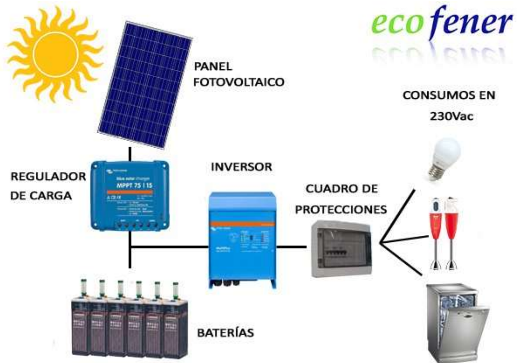
Ilustración 18 Instalaciones Fotovoltaicas aisladas de Red
