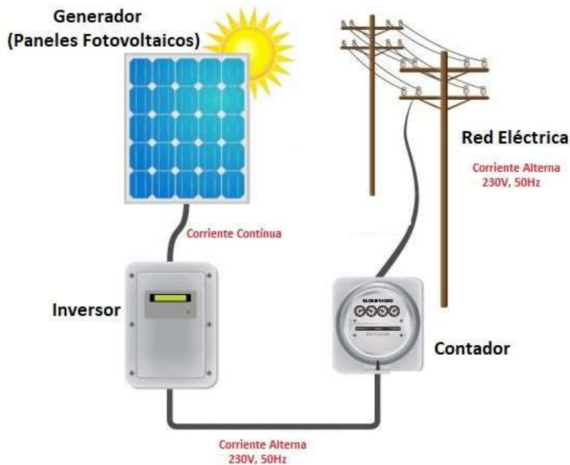
Ilustración 17 Instalaciones Fotovoltaicas de Conexión a Red
