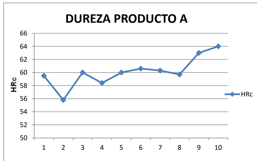
Figura 3.3 VARIACIÓN DE VALORES DE DUREZA EN PRODUCTO A
