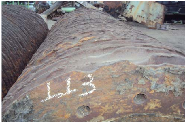
Figura 1.8 VISTA LATERAL DE MAZAS DESGASTADAS
