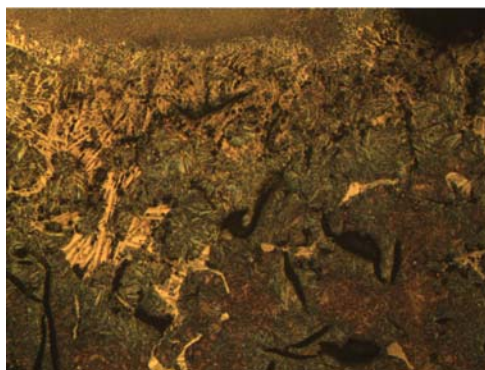
Figura 2.32 ZAT 400X producto B-1
