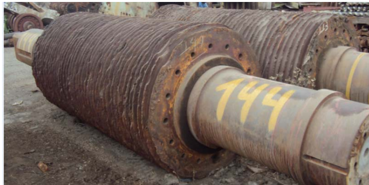
Figura 1.7 VISTA FRONTAL DE MAZAS DESGASTADAS
