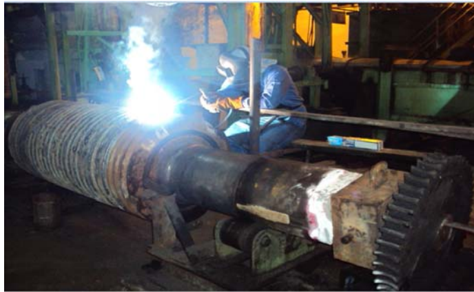
Figura 1.13 FOTOGRAFÍA DURANTE APLICACIÓN DE RECUBRIMIENTO
