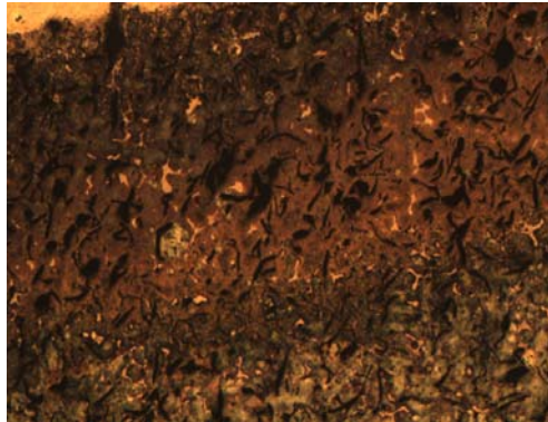
Figura 2.30 ZAT 50X producto B-1
