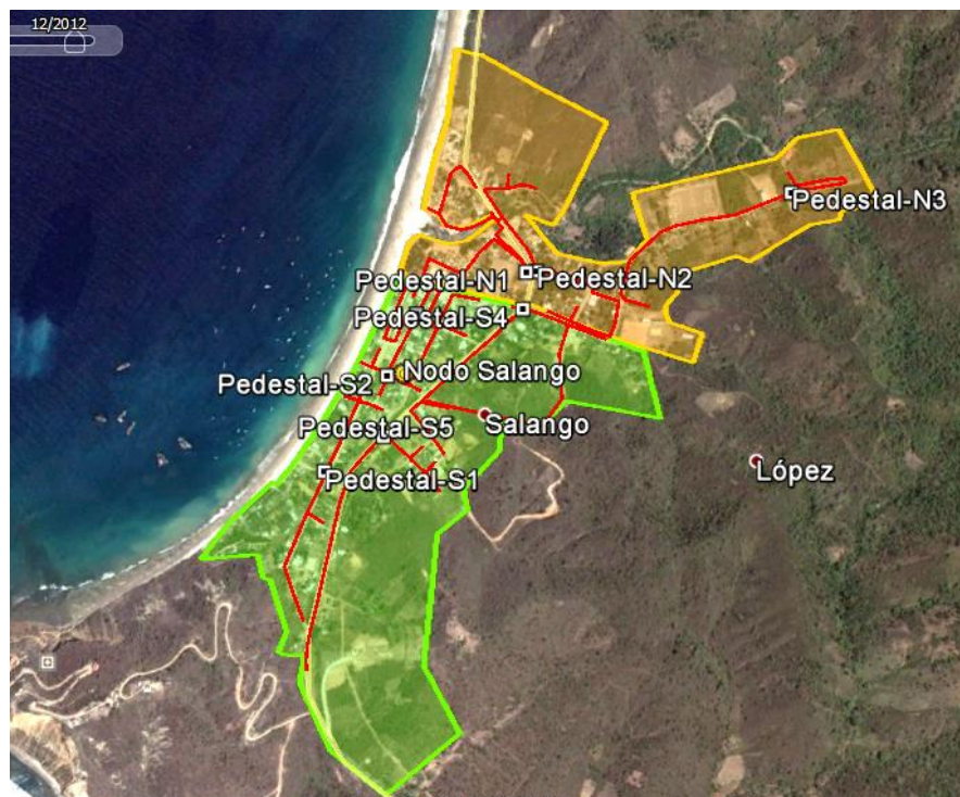
Figura 3.15: Cableado de la Red de Acceso.
