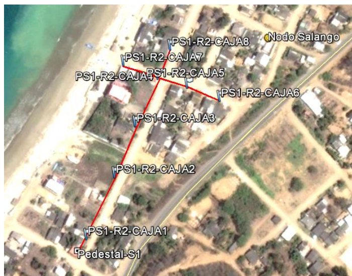
Figura 3.11: Cableado de la Ruta 2 del Pedestal S1.
