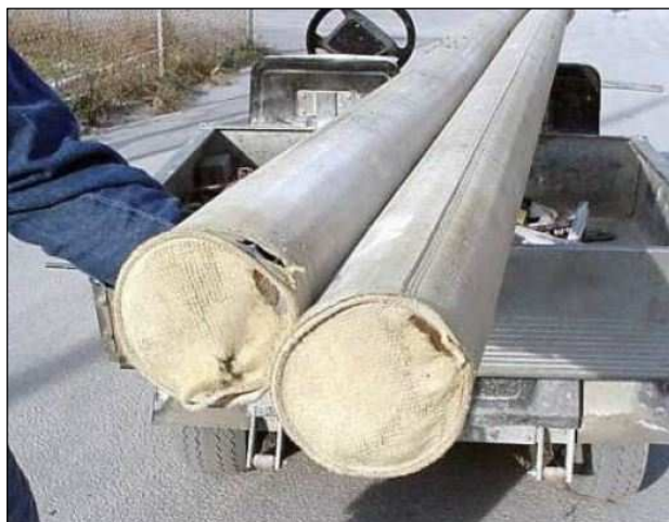
FIGURA 4.5 FALLAS FRECUENTES POR EXCESO DE LIMPIEZA
