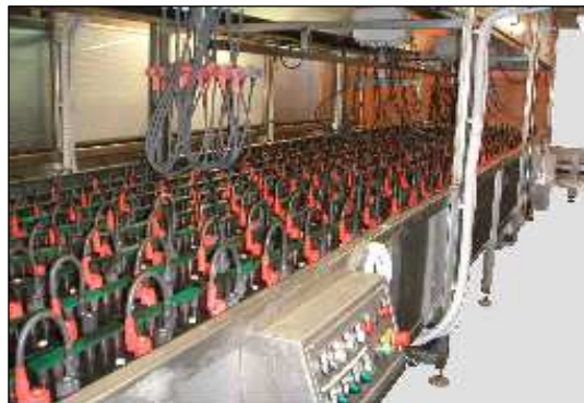
FIGURA 3.20 SISTEMA DE CARGA POR RECIRCULACIÓN DE AGUA (WATER BATH).
