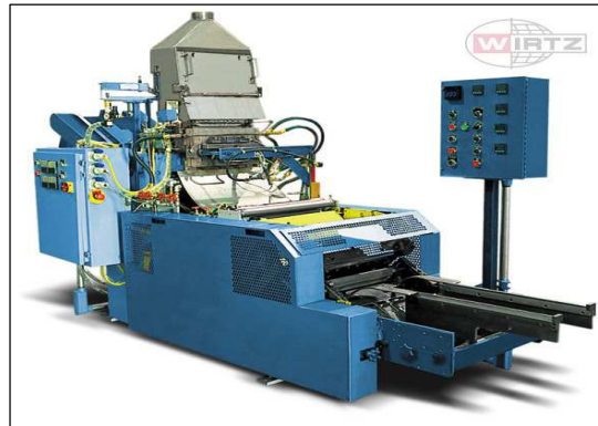
FIGURA 3.2 FABRICACIÓN DE REJILLAS POR GRAVEDAD.
