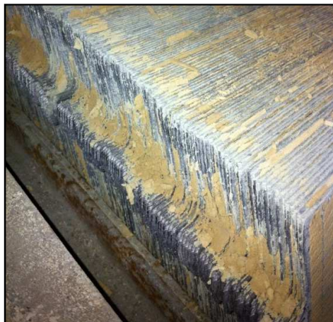
FIGURA 3.12 PLACAS CON EXCESO DE PASTA SECA.
