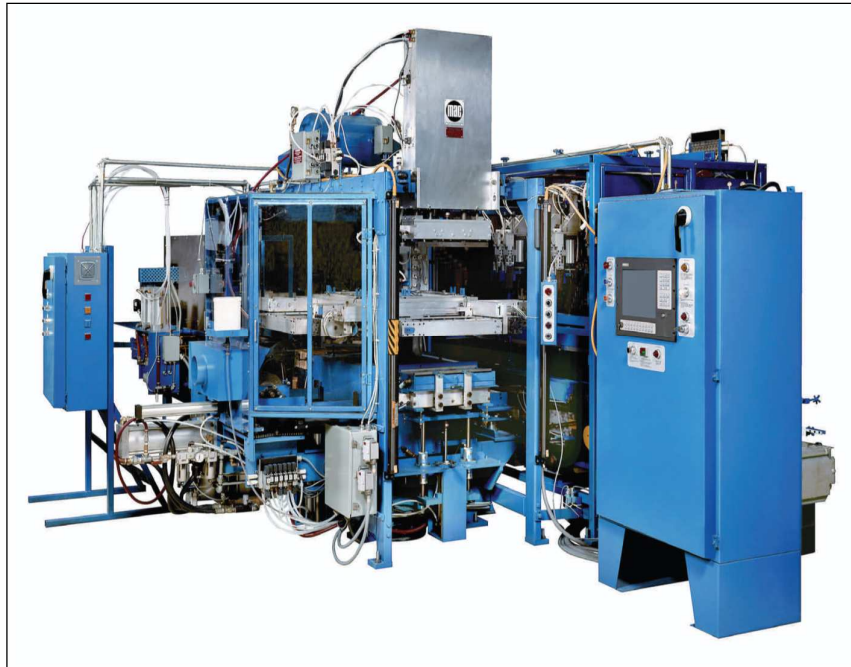
FIGURA 3.17 MÁQUINA DE SOLDADO DE GRUPOS MAC / COS Referencia [36].
