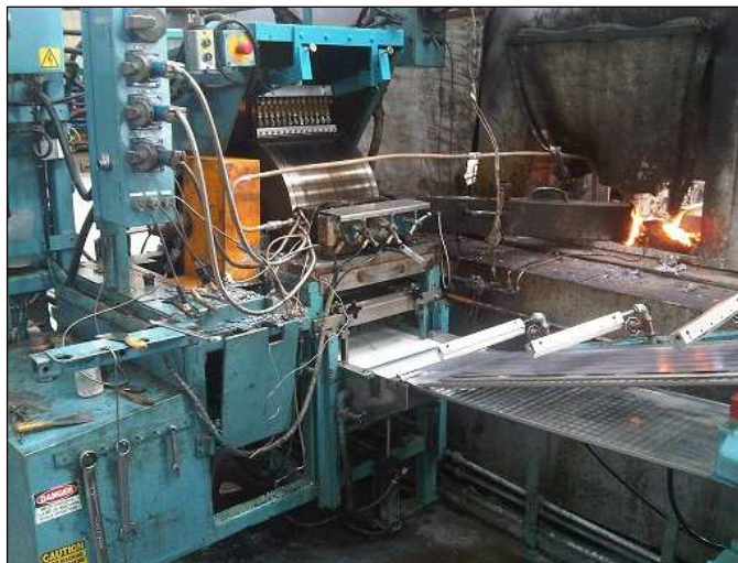
FIGURA 3.3 FABRICACIÓN DE REJILLAS DE MANERA CONTINUA.
