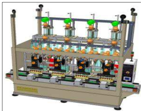
FIGURA 3.19 LLENADORA VOLUMÉTRICA OMI Referencia [38].
