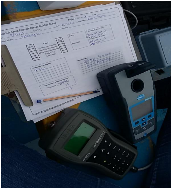
Figura 30. Equipos multiparamétricos usados en el muestreo del río Babahoyo
