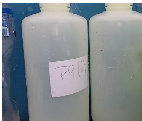
Figura 26. Botellas de PEAD para muestreo de agua. Fuente: Venegas J. 2016
