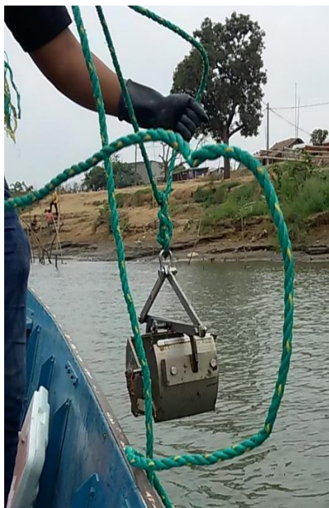
Figura 27. Muestreo de sedimento con draga Van Veen. Fuente: Venegas J. 2016
