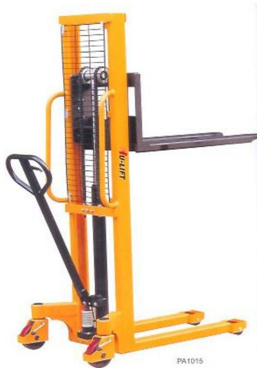
Figura 2.8. Apilador Manual .
