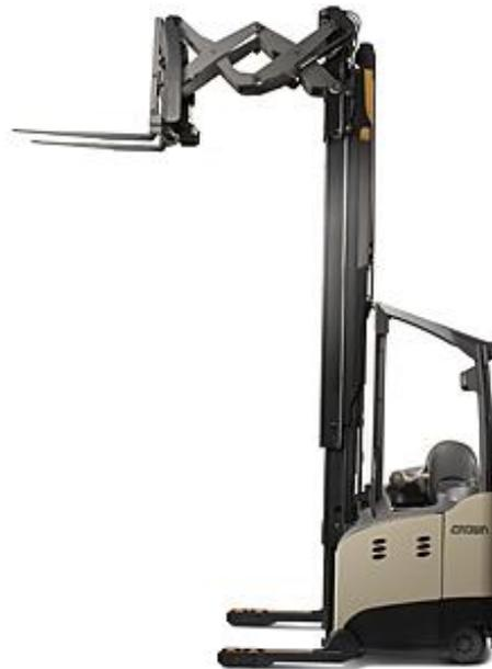
Figura 3.13. Carretillas de contrapeso retráctil tipo double reach.
