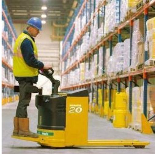
Figura 3.9. Transpaleta eléctrica uso montado.
