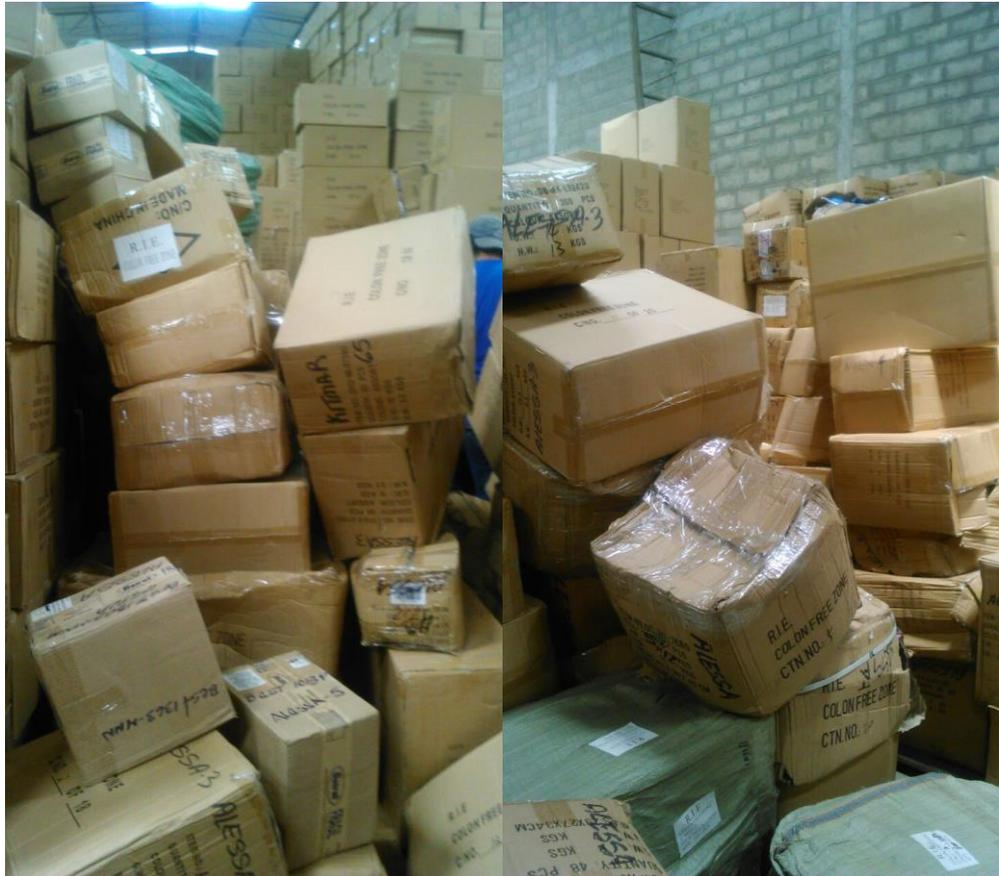
Figura 1.1. Productos mal logrados por mal apilamiento.
