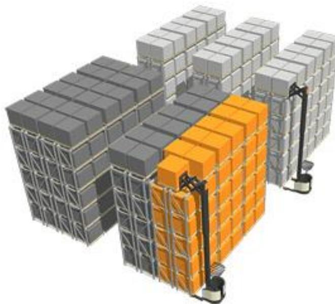
Figura 3.14. Carretillas de contrapeso retráctil tipo double reach con mástil en altura.
