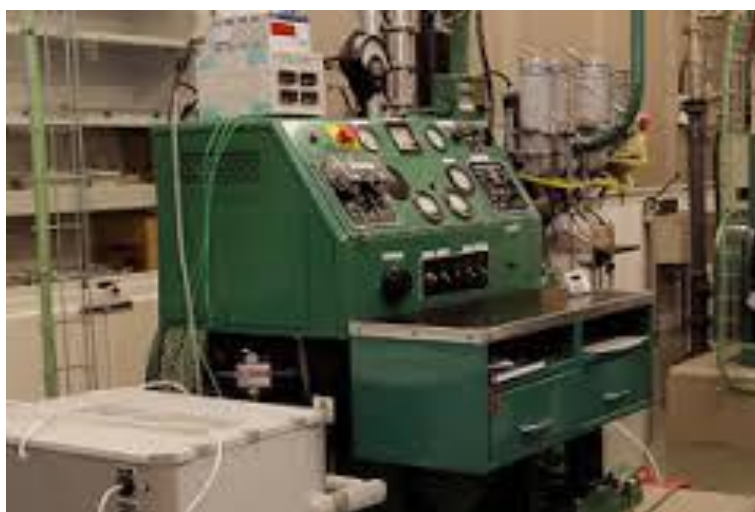
Figura 2. Octanómetro (determinación de RON). FUENTE: Autor
