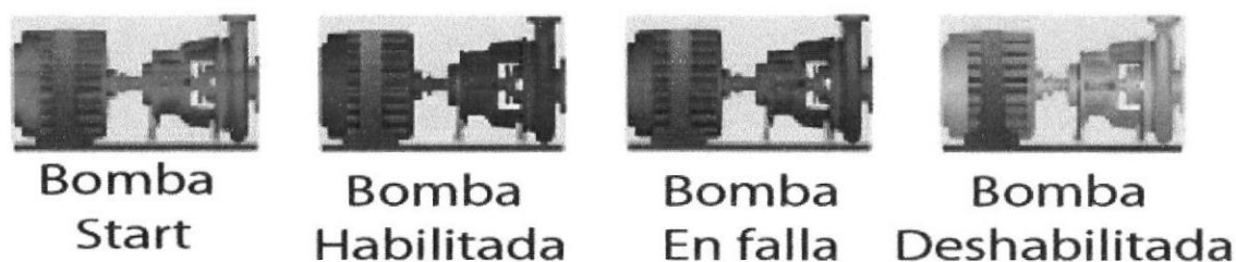
Figura 2.3 Estado de las bombas por colores
