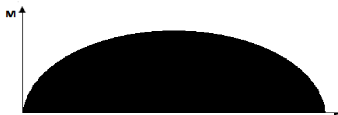
FIGURA 3.7 DIAGRAMA DEL MOMENTO FLECTOR SOBRE LA VIGA.
