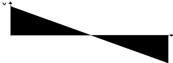
FIGURA 3.6 DIAGRAMA DE ESFUERZOS CORTANTES SOBRE LA VIGA.
