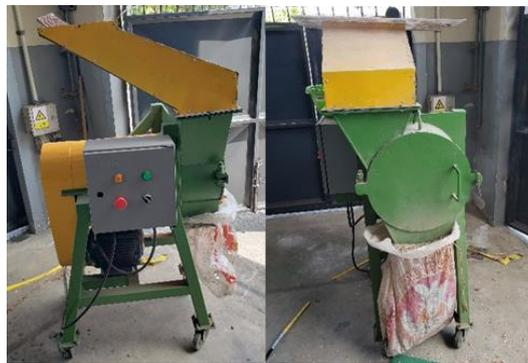
Figura 2.5 Equipo de molienda del CDTS - Molino de Martillo
