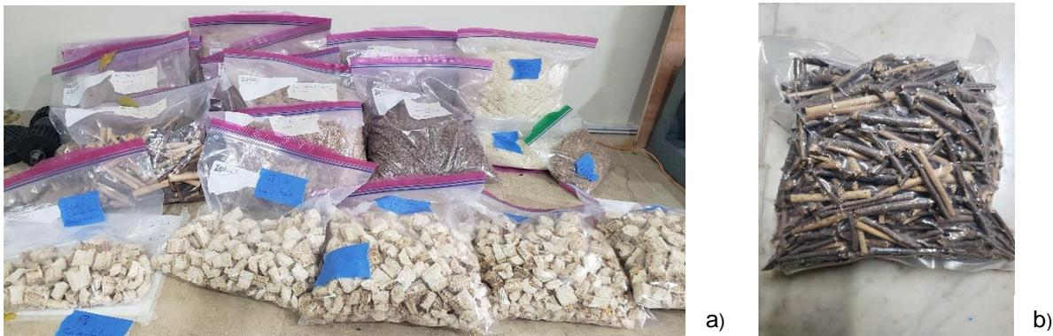
**Figura 4.3 Almacenamiento de Residuos: a) Residuos en bolsas Ziploc – Humedad 11 %, b) Residuos de madera sellado al vacío humedad > 30%**
