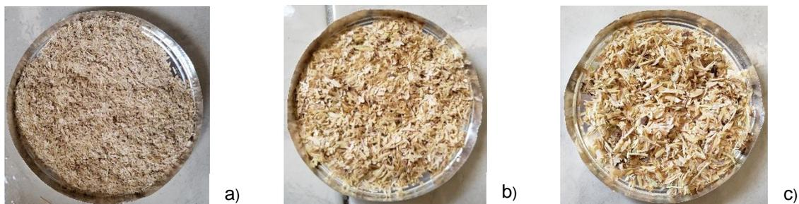
**Figura 3.5 Residuos de cascarilla de arroz molidos y tamizados para diferentes tamaños de partícula: a) < 1mm, b) 1 – 2 mm y c) > 2mm**
