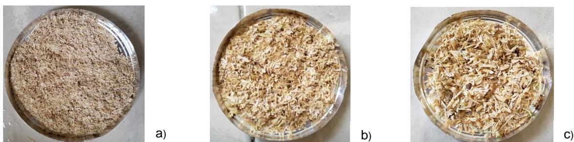
**Figura 4.7 Residuos de Tusa de maíz molida y tamizada para diferentes tamaños de partícula: a) < 1mm, b) 1 – 2 mm y c) > 2mm**
