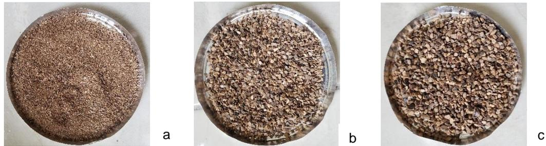
**Figura 4.4 Residuos de mazorca de cacao molida y tamizada para diferentes tamaños de partícula: a) < 1mm, b) 1 – 2 mm y c) > 2mm**
