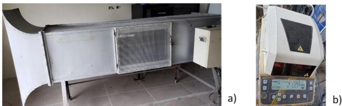
**Figura 2.4 Equipos de secado directo, a) Secador de bandejas y b) Termobalanza**
