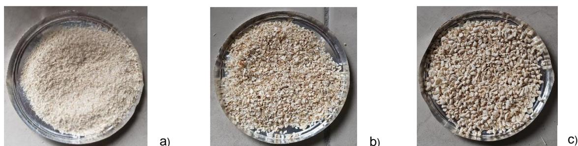
**Figura 3.4 Residuos de tusa de maíz molidos y tamizados para diferentes tamaños de partícula: a) < 1mm, b) 1 – 2 mm y c) > 2mm**
