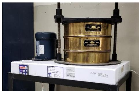
Figura 2.6 Sistema de Tamizado RX - 812 de LOPU (Base + tamiz 1mm + tamiz 2mm)
