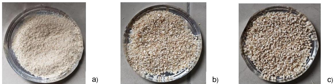
**Figura 4.6 Residuos de Tusa de maíz molida y tamizada para diferentes tamaños de partícula: a) < 1mm, b) 1 – 2 mm y c) > 2mm**
