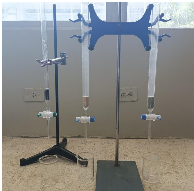
Figura 9. Elaboración de columnas de lecho empacado
