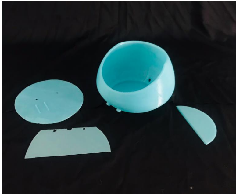
Figura 4.30: Prototipo maceta impreso en PLA, piezas
