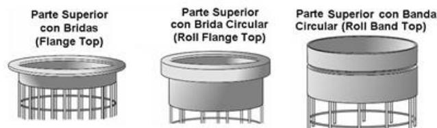
**FIGURA 3.5 TIPOS DE CANASTILLAS [14]**
