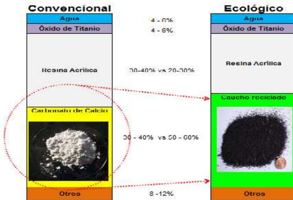
**Figura 14. Comparación de componente de los impermeabilizantes.**
