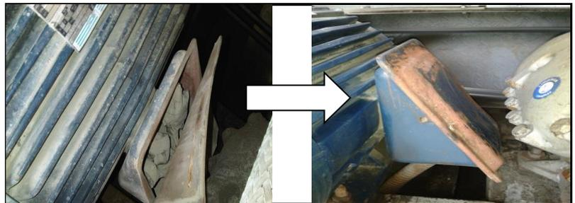
**FIGURA 7.21 ANTES Y DESPUÉS DE TAPA DE CONEXIONES DEL MOTOR**
