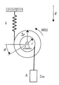
13. El sistema mostrado consiste de una polea de masa m y momento de inercia centroidal I<sub>O</sub>, y de un bloque de masa 2m. La polea es accionada mediante un momento M(t). El cable entre la polea y el bloque permanece en tensión mientras el sistema esta en movimiento. Encuentre la frecuencia natural de oscilacion del sistema, considere desplazamientos pequeños. (14 minutos)
