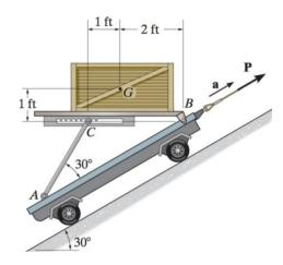
9. Si al carro se le da una aceleración constante a = 6 pies/s² sobre el plano inclinado, La caja tiene un peso W = 150 lb con el centro de gravedad en G, y se fija a la plataforma para que no se deslice. Desprecie el peso de la plataforma, determine la componente horizontal de la fuerza en libras del pasador B. (8 minutos)
