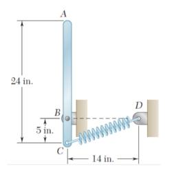
6. Una barra esbelta, de 9 Lb, puede rotar en el plano, con respecto al pivote ubicado en el punto B. El resorte (k=30 Lb/ft), cuya longitud sin deflexión es de 6 in, está acoplado a la barra en la posición mostrada. Si el sistema se libera desde el reposo en la posición mostrada, determine la energia potencial del sistema en lb ft cuando la barra rota 90° en sentido antihorario. (8 minutos)
