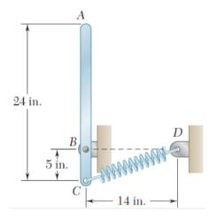
7. Una barra esbelta, de 9 Lb, puede rotar en el plano, con respecto al pivote ubicado en el punto B. El resorte (k=30 Lb/ft), cuya longitud sin deflexión es de 6 in, está acoplado a la barra en la posición mostrada. Si el sistema se libera desde el reposo en la posición mostrada, determine la velocidad angular en rad/s de la barra cuando rota 90° usando el método de energia. (10 minutos)
