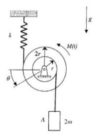
12. El sistema mostrado consiste de una polea de masa m y momento de inercia centroidal I<sub>O</sub>, y de un bloque de masa 2m. La polea es accionada mediante un momento M(t). El cable entre la polea y el bloque permanece en tensión mientras el sistema esta en movimiento. Escriba las ecuaciones del movimiento del bloque y la polea en términos del ángulo de giro de la polea (8 minutos)
