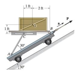
Si al carro se le da una aceleración constante a = 6 pies/s² sobre el plano inclinado, La caja tiene un peso W = 150 lb con el centro de gravedad en G, y se fija a la plataforma para que no se deslice. Desprecie el peso de la plataforma, determine la componente vertical de la fuerza en libras del pasador B. (8 minutos)
