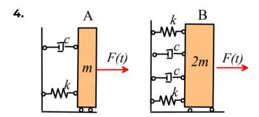
Los sistemas A y B en la figura mostrada están sujetos a la misma fuerza armónica F(t). La amplitud de vibración en estado estable del sistema A se mide en 1 mm. La amplitud de vibración en estado estable del sistema B es
