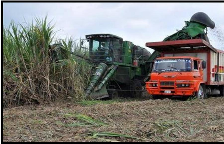
Imagen 4. Corte y llenado de camiones con cosechadora
