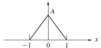
**Tema 4** (15 puntos). La entrada a un filtro es un ruido blanco con media cero y densidad espectral de potencia  $N_0/2$ . El filtro tiene la función de transferencia mostrada:
