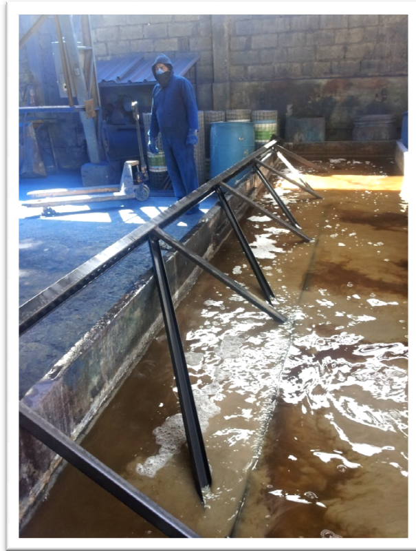
FIGURA 1.1 LIMPIEZA DE SUPERFICIE DE PRODUCTO POR BAÑO EN ÁCIDO
