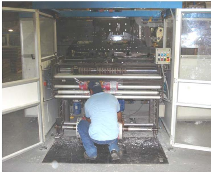
FIGURA 3.6 CAMBIO DE POLIETILENO EN QWRAP
