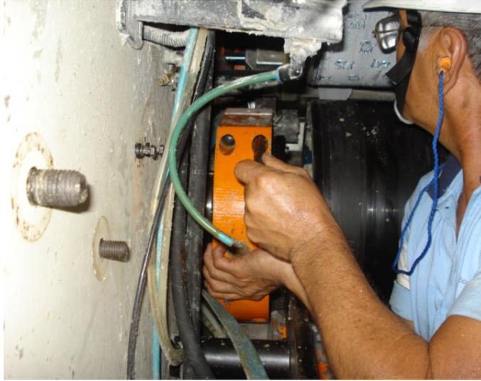
FIGURA 3.9 MECÁNICO AFLOJANDO LAS BRIDAS DE LOS RODAMIENTOS
