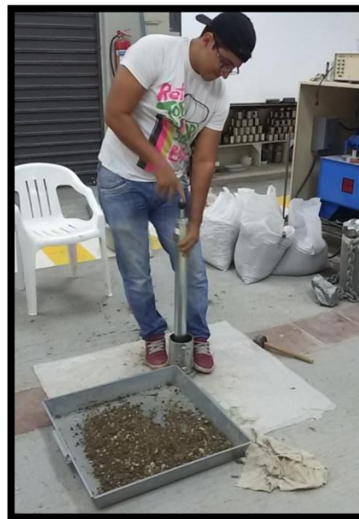
Figura 30.- Ensayo de Compactación
