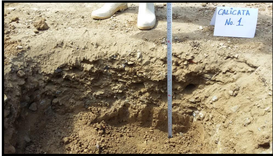
Figura 11.- Calicata #1 excavación a toma de muestras a 0,50 m
