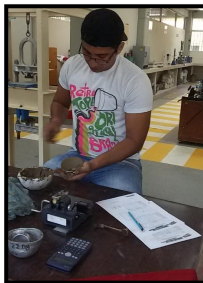
Figura 23.- Ensayo Límites de Atterberg
