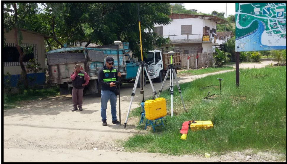
Figura 6.- Toma de Coordenada Inicial (Base) del Plano Topográfico
