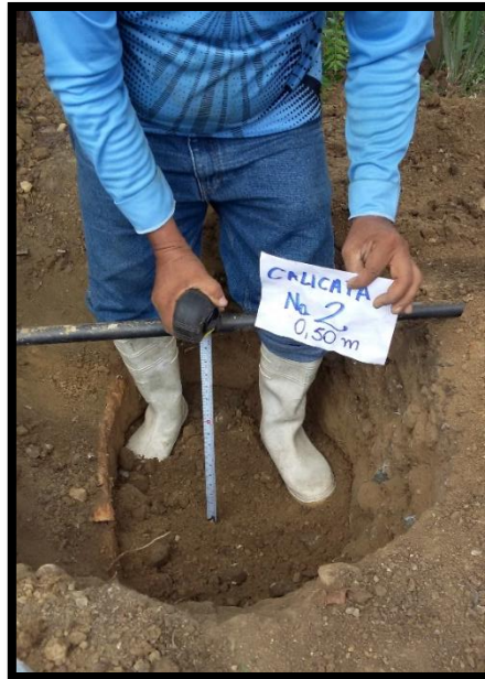
Figura 14.- Calicata #2 excavación a toma de muestras a 0,50 m
