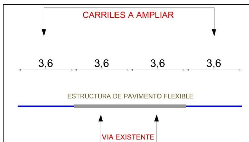
**Ilustración 4.2:** Esquema preliminar de ampliación de vía con pavimento flexible.
