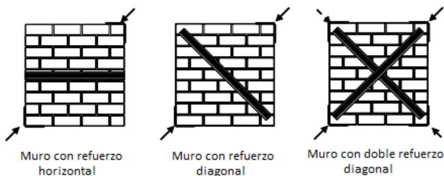
**Figura 4.2** Formas de colocar la lámina de FCRP para el refuerzo de muros de mampostería
