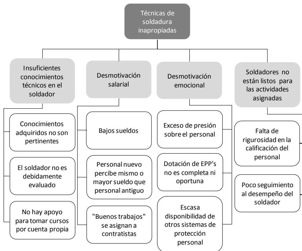
Figura 20. Aplicación de Técnicas de Soldadura Inapropiadas-Causas
