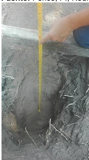
Figura 2-14 Calicata de 1m de profundidad Fuente: Ponce, P., Rodríguez, CH., 2016.
