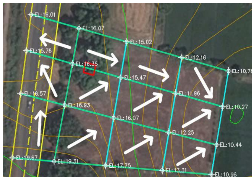
Figura 2-8 Cuadrícula de Elevación del terreno y Líneas de Flujo de Agua Fuente: Google Earth, Civil 3D Elaborado por: Ponce, P., Rodríguez, CH., 2016.
