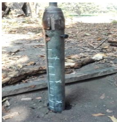
Figura 2-18 Tubo Shelby usado en el sitio. Fuente: Ponce, P., Rodríguez, CH., 2016.
