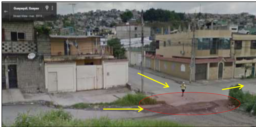
Figura 5.9 Punto crítico (C3), erosión y acumulación de AALL provenientes de las subcuencas A y C.
