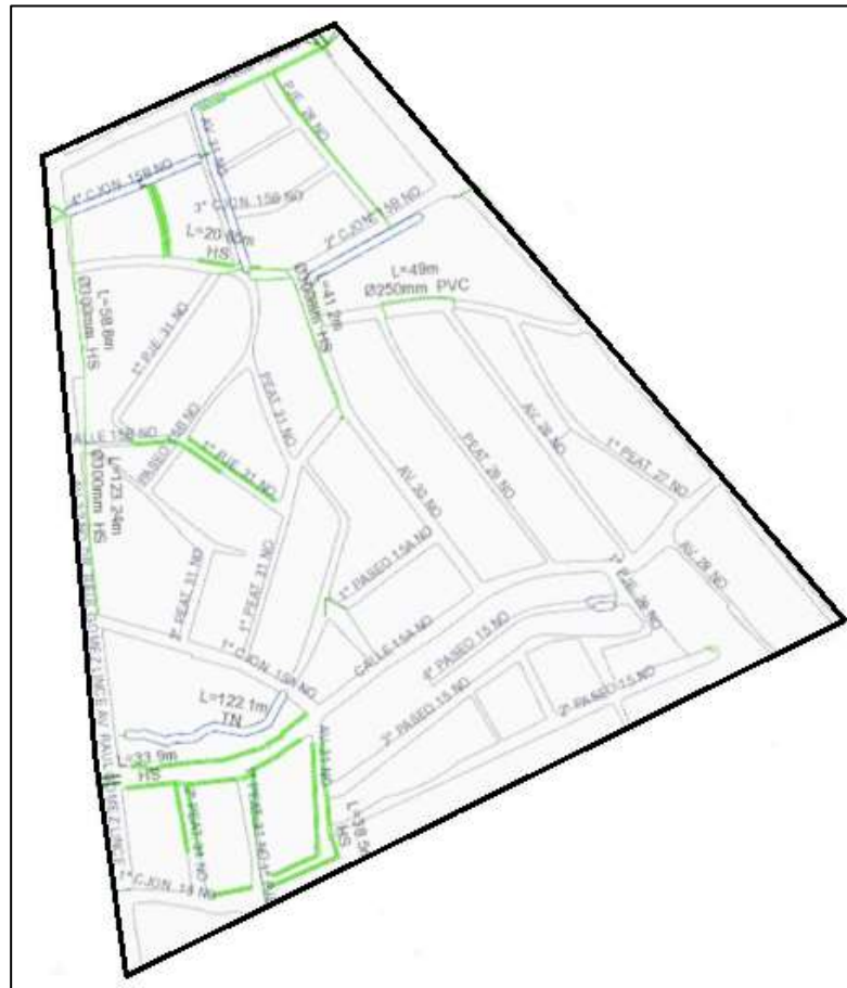
Figura 3.14 Ausencia de alcantarillado pluvial en Urbanor. Fuente: INTERAGUA.
