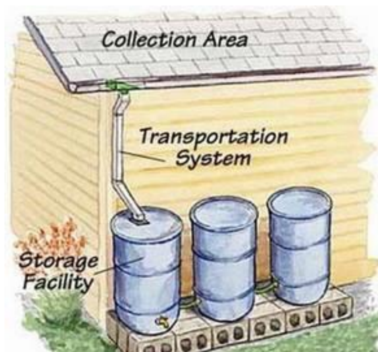
Figura 5-1 Sistema de Captación de Aguas Lluvias Fuente: (Horticultora60, 2015)
