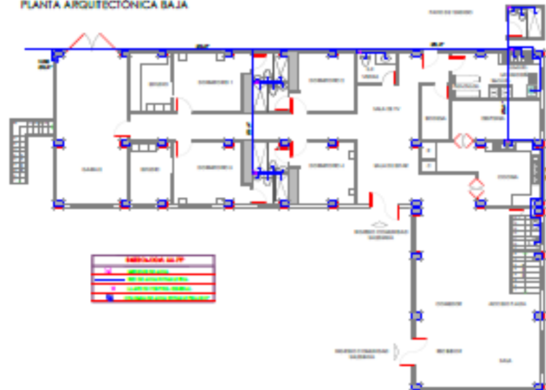
RED DE AGUAS POTABLE PLANTA ARQUITECTÓNICA BAJA
