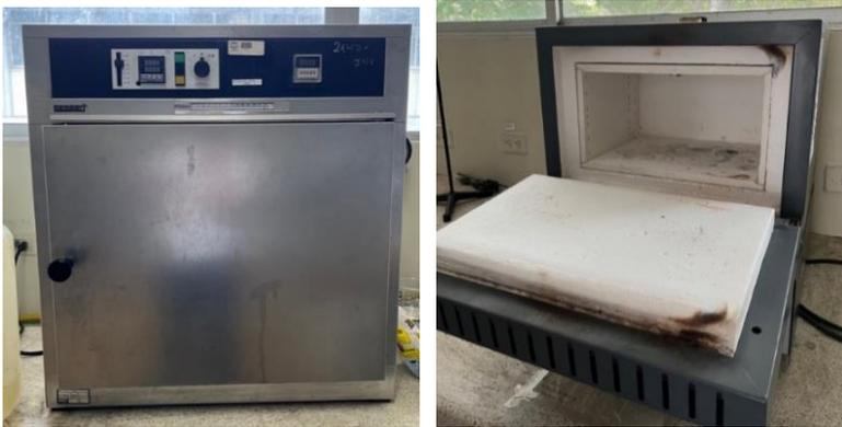
Posteriormente, se colocó la muestra de lodo en una mufla a 350 °C durante 2 horas, para eliminar la materia orgánica presente ya que esta puede influir negativamente en el desempeño del lodo en el ladrillo.
