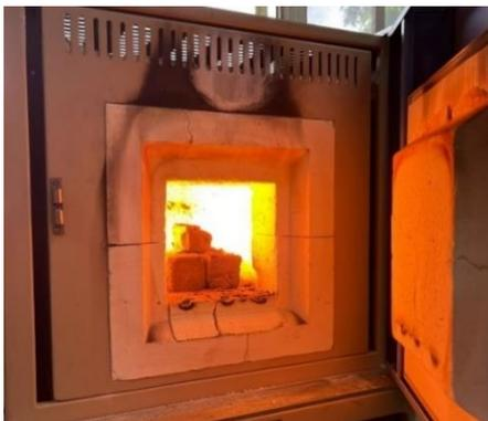
Como se indicó en el diseño experimental de bloques de construcción, se ingresó un bloque de cada composición dentro de la mufla. Cabe mencionar que se retiró el molde de madera para evitar incendios dentro del equipo, lo cual provocó que algunos bloques se resquebrajen durante el proceso de desmolde.
