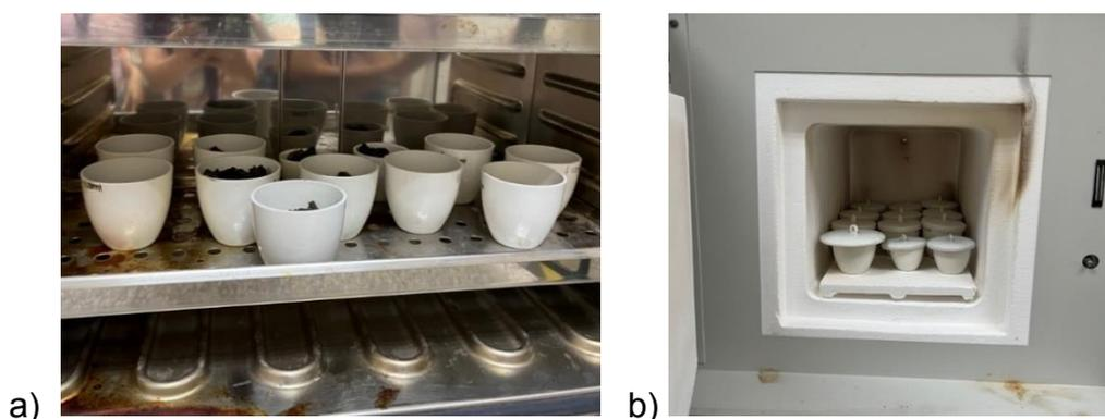
*Nota: Equipo utilizado en el Laboratorio de CADS, Espol. Crisoles a) en el horno para secado y b) en la mufla para incineración*
