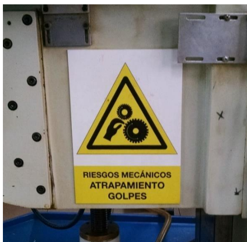
FIGURA 3.43: Señal de advertencia de Riesgos Mecánicos de la Fresadora Universal del Laboratorio CAMPRO
