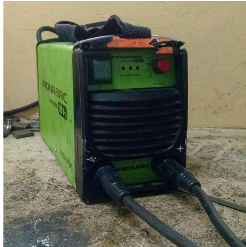
FIGURA 3.19: Equipo para soldar portátil del Laboratorio CAMPRO
