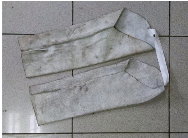
FIGURA 3.26: Mangas para soldar del Laboratorio CAMPRO
