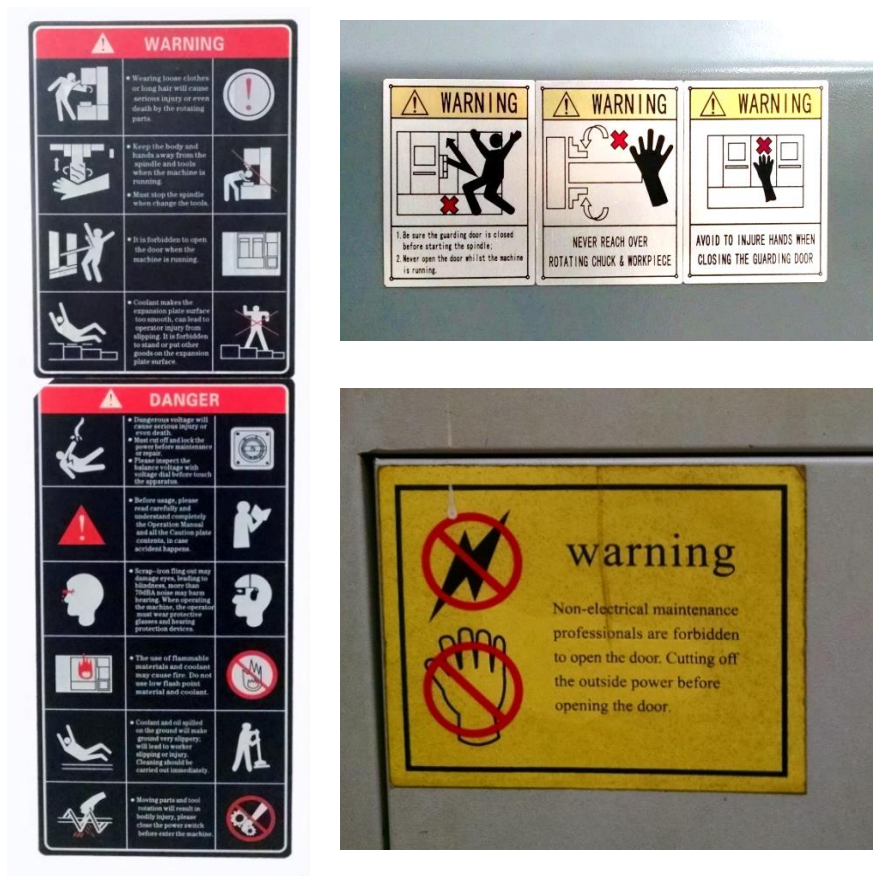
FIGURA 3.46: Señales de advertencia de máquinas herramientas del Laboratorio CAMPRO
