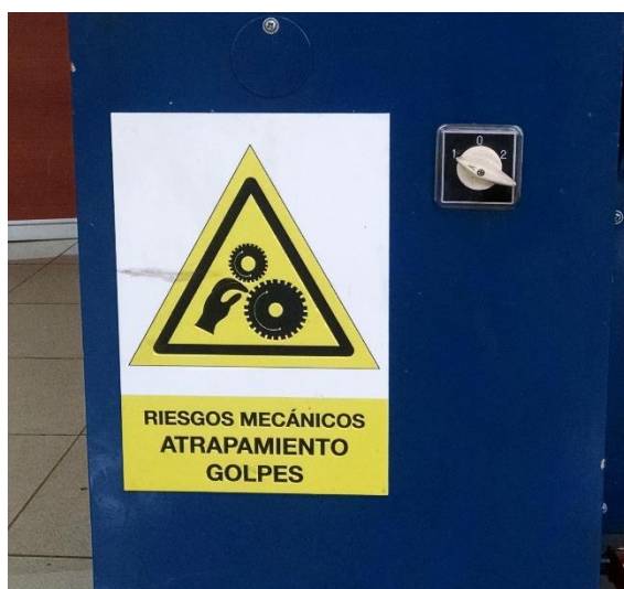
FIGURA 3.44: Señal de advertencia de Riesgos Mecánicos del Torno Convencional del Laboratorio CAMPRO
