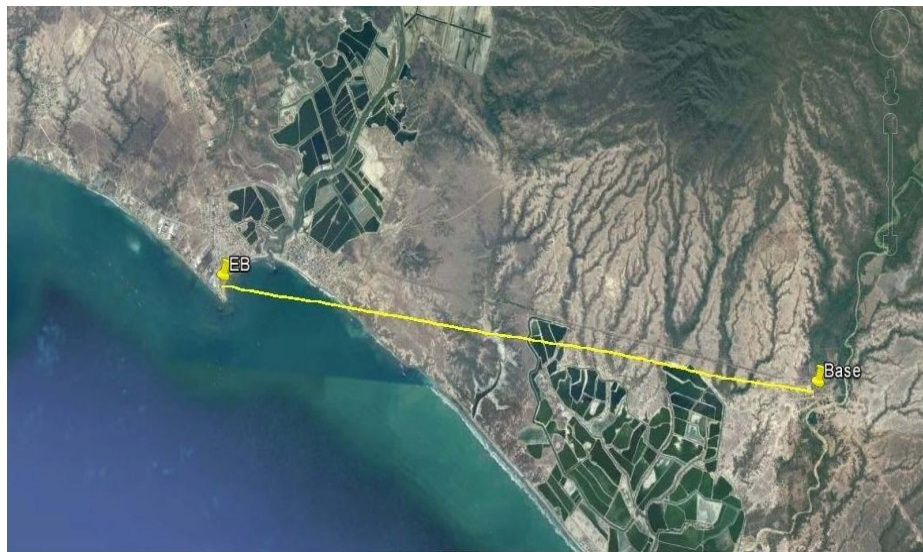
Figura 3.18. Línea de vista entre la Estación Base en el puerto Chanduy y la comuna de Tugaduaja
