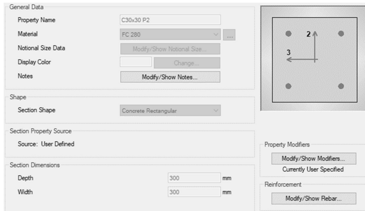
Figura 3.25: Modelado de columna 1.
