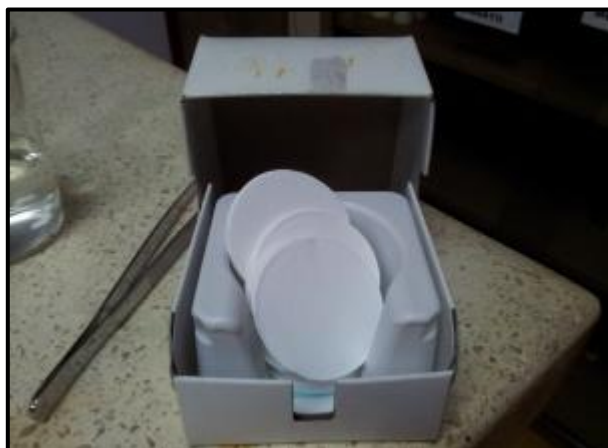
Figura 3-4: Filtros de fibra de vidrio Fuente: Yagual, 2012
