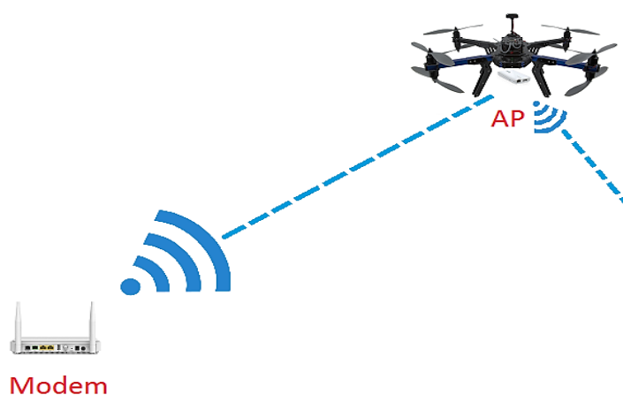
Figura 2.17: Ampliación de la cobertura con el access points en el drone.
