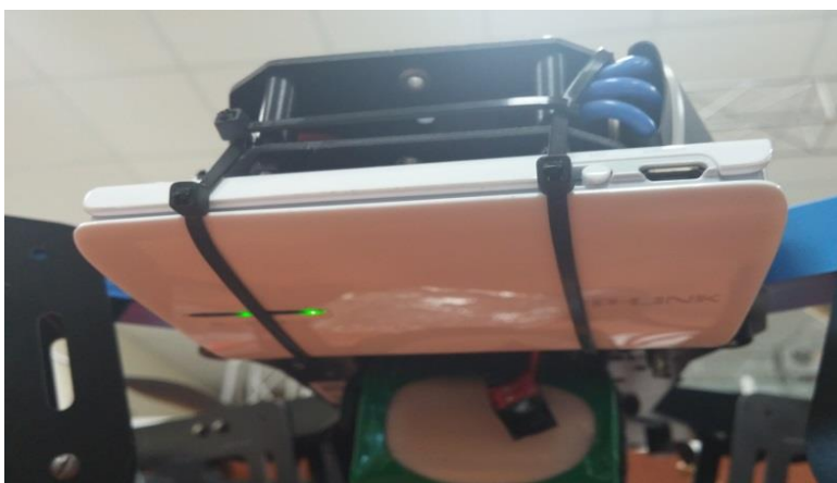
Figura 2.40: Vista inferior del drone equipado con el access point.
