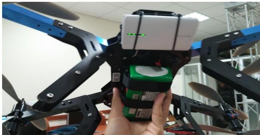
Figura 2.41: Funcionamiento del access ubicado en el drone.
