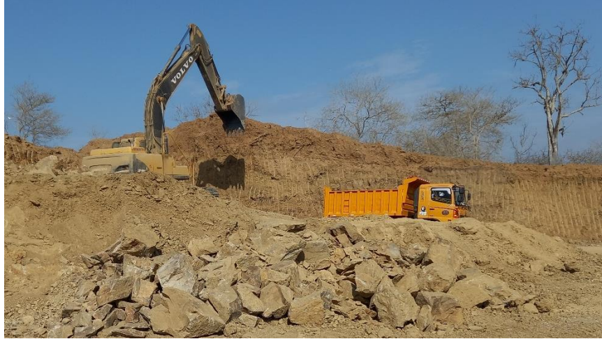
Figura 1.3 Carga y transporte Volvo EC240CL y Volqueta Hino
