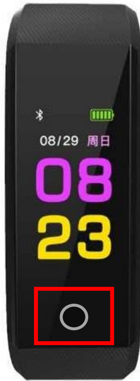
Figura A6.7 - Ubicación sensor touch. [autoría propia]
