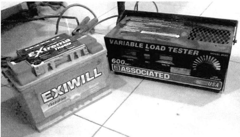
Figura 22. Batería y descargador de baterías
