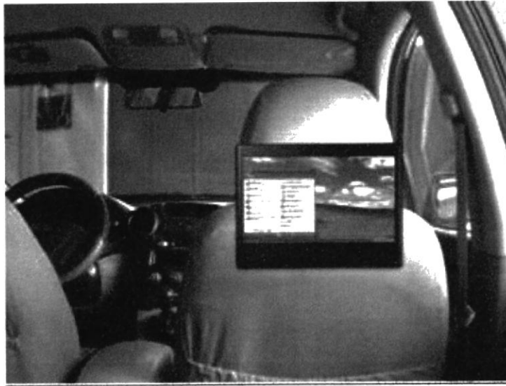
Figura 4-7: Monitor asegurado en el respaldo del asiento.
