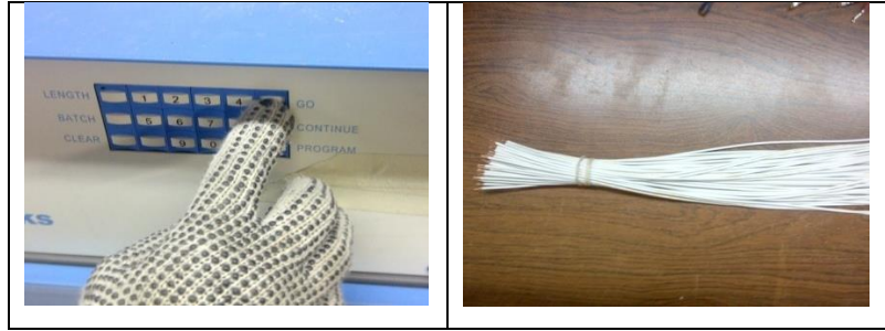
FIGURA 12: PROCESO DE CORTE DE CABLES
