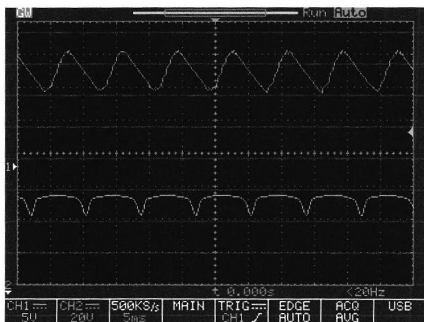
Figura 5.12. Ch2: Rizado de voltaje  $V_o$ , Ch1: Modulación del ciclo de trabajo ante un alto consumo en la carga.
