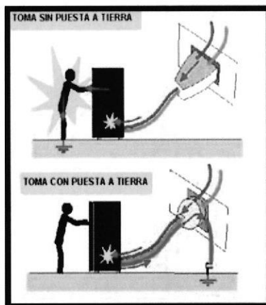
Gráfico 3-3-16: Protección de puesta a tierra. Fuente: http://hogar.yoreparo.com
