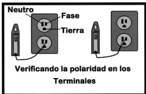
Gráfico 3-3-12: Polaridad de la toma corriente. Fuente: http://netconexion.blogspot.com/
