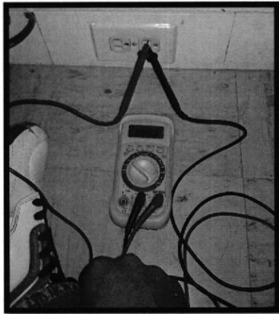
Gráfico 3-3-13: Medición entre Fase y Neutro.
