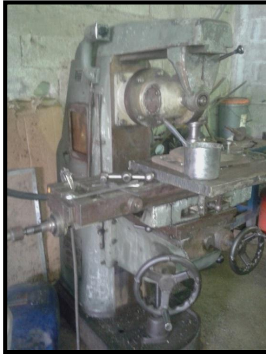
FIGURA 1.2. MAQUINA FRESADORA TÍPICA USADA PARA MAQUINADO DE METALES.
