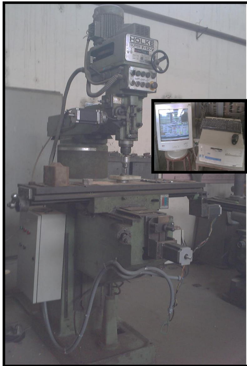
FIGURA 3.5. Fresadora convertida a Maquina CNC
