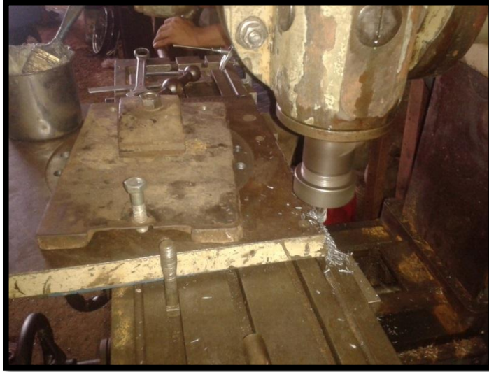
FIGURA 1.4. PROCESO DE ARRANQUE DE VIRUTA EN TALLERES ARTESANALES
