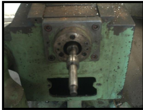
FIGURA 2.8. EJE “Y” DE LA MESA DE TRABAJO SIN LOS MOTORES DE LA MÁQUINA.
