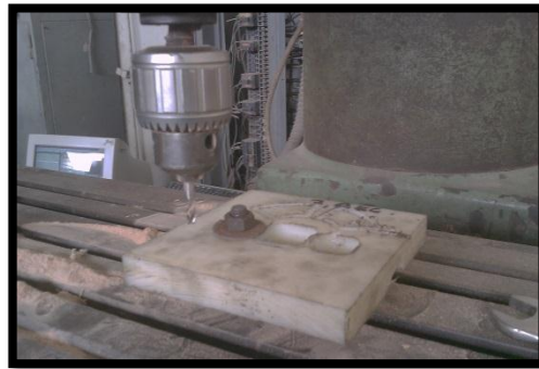
FIGURA 3.8. COLOCACIÓN DEL CERO DE PIEZA
