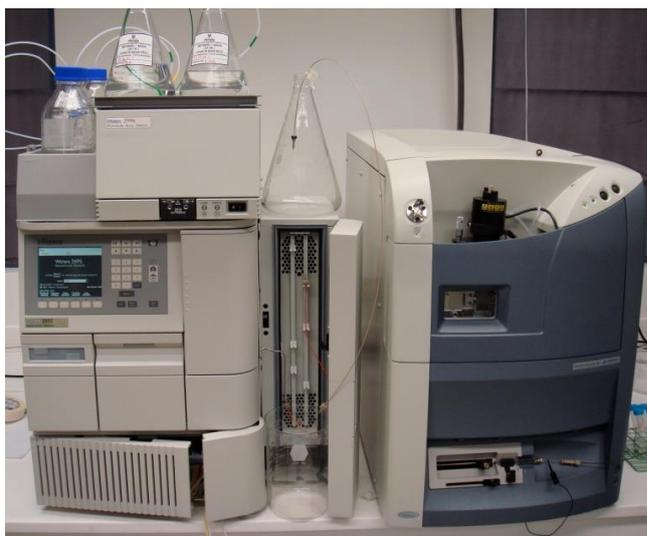
**Figura 4:** Cromatógrafo líquido acoplado a espectrómetro de masas Quattro Premier™ XE. Sistema HPLC/MS/MS
