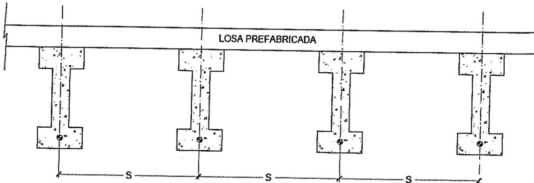
Realizar un bosquejo de la viga con sus dimensiones y la ubicación del acero de presfuerzo.
