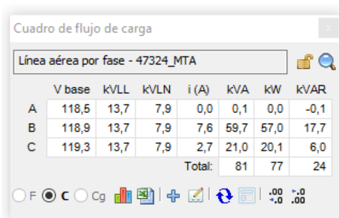
Anexo 25 Flujo de carga en tramo 47324_MTA.
